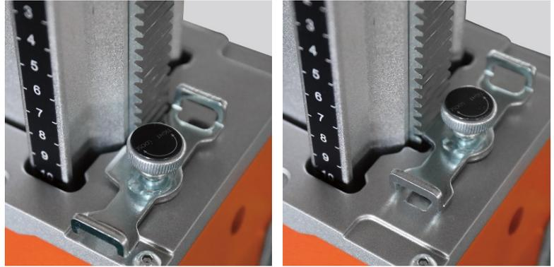
Schieben Sie die Schlittenverriegelung nach links, um den Schlitten zu entriegeln, kurbeln Sie dann den Bohrschlitten nach oben oder unten in die gewünschte Position und schieben Sie die Hebelverriegelung nach rechts, um den Bohrschlitten zu arretieren. Nachdem Sie die gewünschten Einstellarbeiten wie z. B. das Einsetzen des Motors vorgenommen haben, entriegeln Sie die Verriegelungsvorrichtung und ziehen Sie die Rändelschraube an der Hebelsperre fest, um den Betrieb aufzunehmen.
