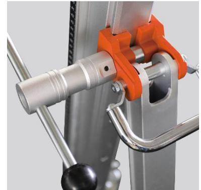
Lösen Sie die Klemmschraube an der Säulenstütze und stellen Sie den Winkel gemäß der Scala auf der Bohrsäule ein. Sobald der Winkel eingestellt ist, ziehen Sie die Klemmschraube wieder fest. Vergewissern Sie sich, dass der Befestigungsadapter und der Schlitten fixiert ist.
