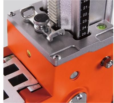
Stellen Sie den Winkel des Bohrständlers anhand der Bohrmittle des gewünschten Bohrlochs auf die Position ein. Der einstellbare Bohrwinkel reicht von 0° bis 45°. Wenn Sie in 45° bohren müssen, lösen Sie die Klemmschraube mit der aufsteckbaren 13mm-Kurbel.
