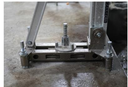
Bei der Verankerung auf einer Ziegelwand müssen ein spezieller Mauerwerksanker und ein Ziegelbefestigungssatz verwendet werden. Die Verwendung eines Betoneinschlagankers in Ziegel könnte zu einem Ziegelbruch und einer Lockerung des Ankers führen!
