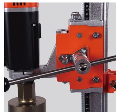
Der KBS-252/M-PRO verfügt sowohl über einen Klemmbügel als auch über einen Befestigungsadapter. Beide Befestigungsmethoden hängen vom Typ des Bohrers ab. z.B. ist der DKB-202/H-PRO ein handgehaltener Bohrer, dieser muss mit der Klemmhalterung verwendet werden, wenn er am Ständer montiert wird.
